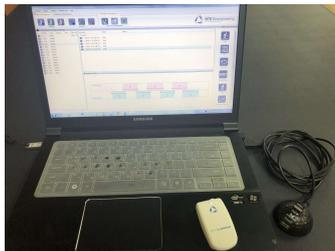
그림3. 무선 관성 감지 장치
